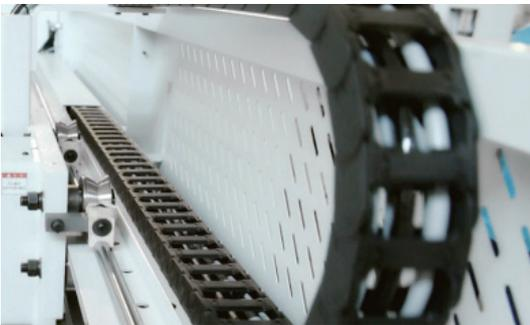
Cadena de cables flexible. Garantiza un movimiento estable y rápido del empujador neumático.
