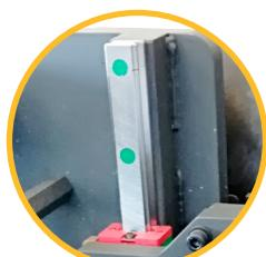
» SUAVE DESLIZAMIENTO de elevación mediante guías Star y patines de recirculación de esferas
